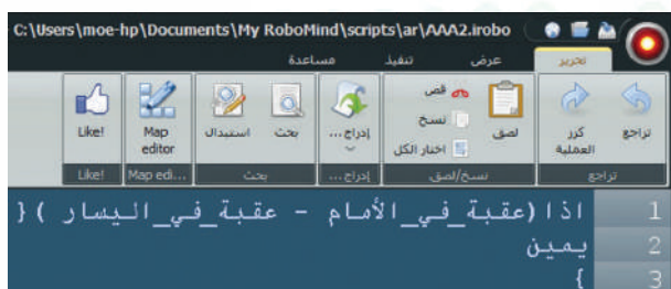
شكل (٤-٦-٥): أمر برمجي لشرط ينفذ فيه يقوم الروبوت مهمة إذا تحقق أحد أوامر المشاهدة.
