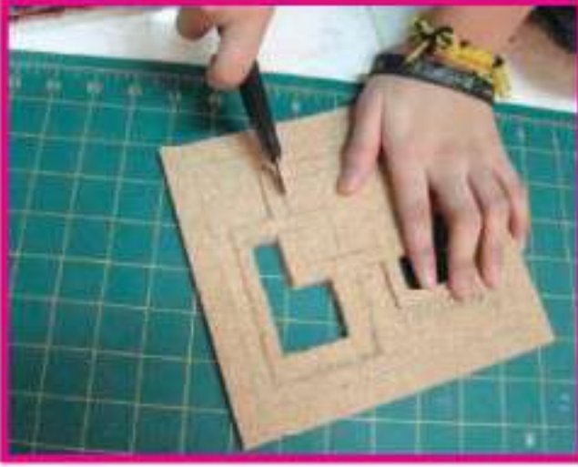
الشكل (١٣٢-ج): التفريغ على الفلين المضغوط
