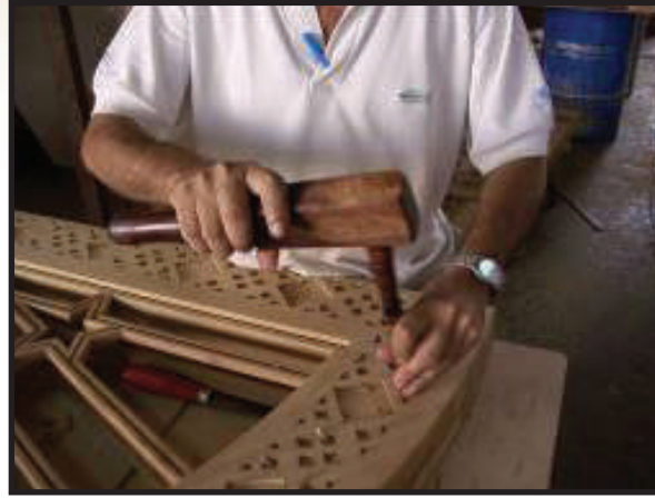
(١): استخدام المدق الخشبي، وهي الأداة الصحيحة.
