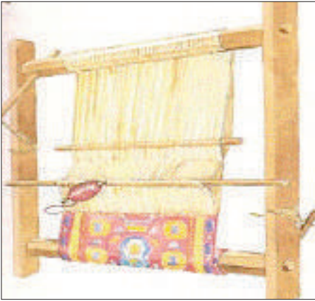
الشكل ( ١٧٧ ) : نول الكليم ويلاحظ فيه تباعد خيوط السدى بما يتناسب مع التصميم المرسوم .
