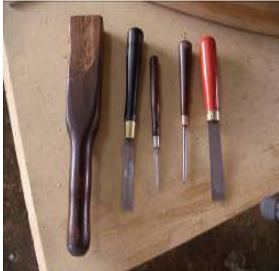
الشكل (١٥٦): الأدوات التي يستخدمها الفنان في الحفر على الخشب، مجموعة أزاميل، ومدق خشبي.
