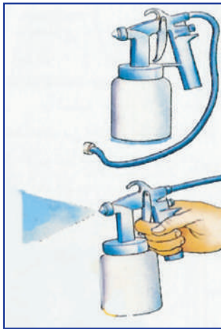
الشكل (٣٥): بخاخة موصلة بمضخة.
