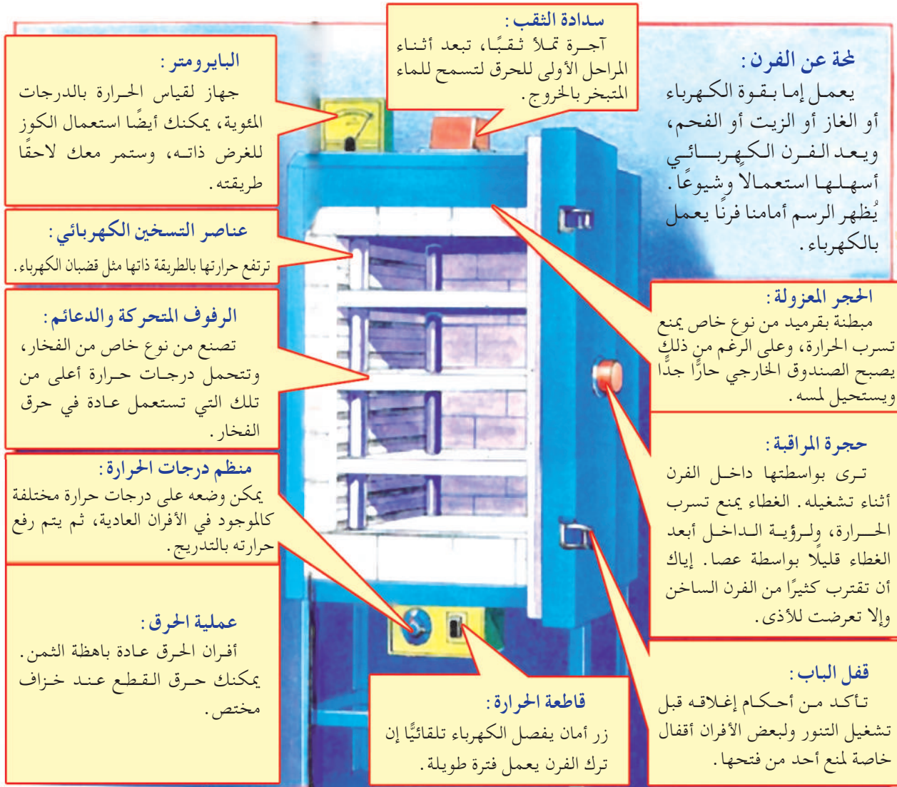
الشكل ( ٥٩ ) : الأفران الحديثة أو الكهربائية والأجزاء التي تتكوّن منها.
