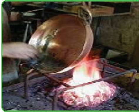
الشكل (٧٢): التخمير «تسخين المعدن لإكسابه اللدونة».
