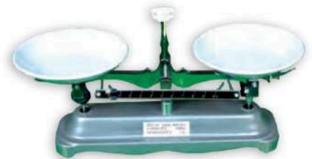
يستخدم الميزان ذو الكفتين لقياس الكتلة.
