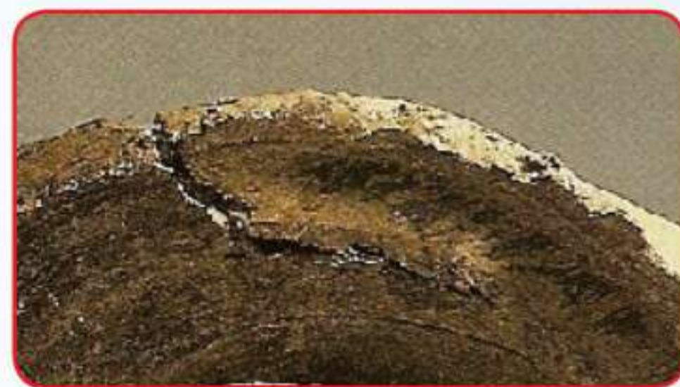
شكل (١١٠): يوضح نتائج أخطاء التجفيف (تشقق).
