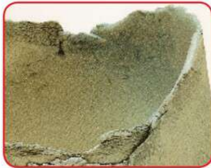
شكل (١١٠): يوضح نتائج أخطاء التجفيف (تشقق).
