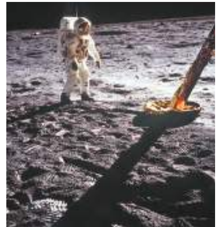
■ الشكل 2-6 إن رائد الفضاء ومركبته يولدان ضغطاً على سطح القمر. إذا كانت كتلة المركبة 7300 kg تقريباً، وتستقر على أربعة أقدم قطر كل منها 91 cm، فما مقدار الضغط الذي تؤثر به على سطح القمر؟ وكيف تستطيع أن تقدر الضغط الذي يؤثر به رائد الفضاء.
