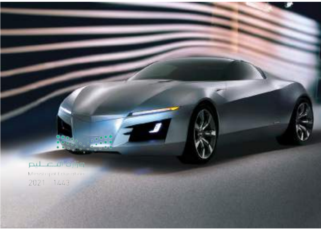
■ الشكل 6-17 تدفق خطوط للهواء فوق سيارة جرى اختبارها في نفق رياح.
