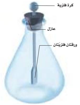
■ الشكل 8-5 الكشاف الكهربائي؛ جهاز يستخدم للكشف عن الشحنات الكهربائية. في الكشاف الكهربائي المتعادل تكون الورقتان معلقتين رأسياً بحرية، وتلامس إحداهما الأخرى.
