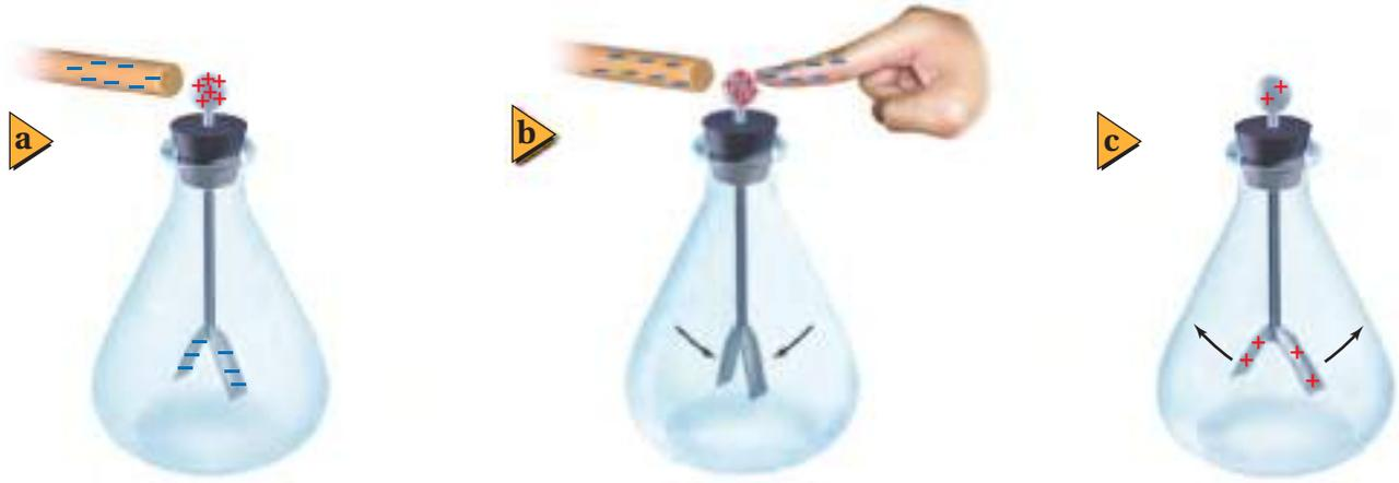
■ الشكل 11-5 يحث قضيب سالب الشحنة على فصل الشحنات على الكشاف الكهربائي (a). يتم تأريض الكشاف الكهربائي عن طريق لمسه، فتنتقل الإلكترونات السالبة من الكشاف الكهربائي إلى الأرض (b). يفصل تأريض الكشاف قبل إبعاد القضيب، فيصبح الكشاف الكهربائي موجب الشحنة (c).
