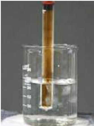
**الشكل 4-14** يزاح الاتزان في اتجاه التفاعل الماص للحرارة نحو اليمين، وهذا من شأنه أن يزيد من إنتاج  $\text{NO}_2$  (لونه بني غامق)، بينما يصبح لون مزيج التفاعل أخف عند وضعه في حمام الماء البارد؛ لأن الاتزان يزاح في اتجاه التفاعل الطارد للحرارة نحو اليسار؛ إذ يزداد تحول  $\text{NO}_2$  إلى  $\text{N}_2\text{O}_4$  الذي لا لون له.
