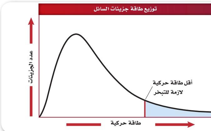
**الشكل 1-24** يوضح الرسم البياني التوزيع المثالي للطاقة الحركية للجسيمات في سائل عند درجة حرارة  $25^{\circ}\text{C}$ . وتقع أكبر طاقة محتملة للجسيمات على قمة المنحنى. **صف** شكل المنحنى للسائل نفسه عند  $30^{\circ}\text{C}$ .
