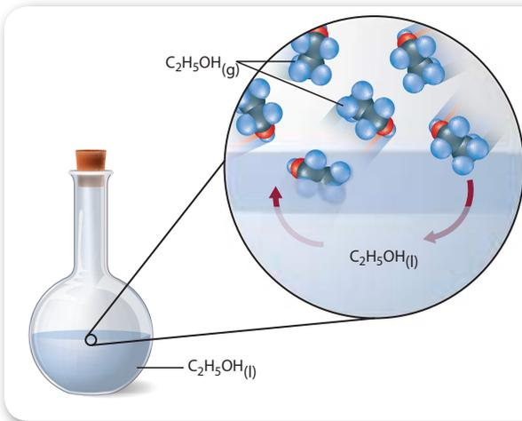
**الشكل 4-8** عند الاتزان، تكون سرعة تبخر الإيثانول  $C_2H_5OH$  مساوية لسرعة التكثف. يسمى هذا الاتزان المكون بين حالتين فيزيائيتين للمادة الاتزان غير المتجانس. تعتمد قيمة  $K_{eq}$  على  $[C_2H_5OH(g)]$  فقط.
