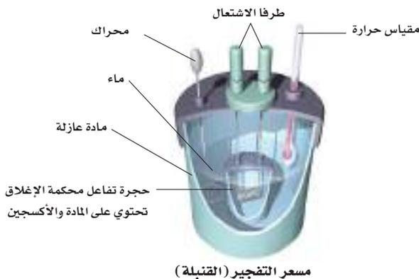
**الشكل 4-2** وضعت عينة في حجرة فولاذية داخلية تسمى القنبلة، مملوءة بالأكسجين المضغوط ضغطاً عالياً، وحول القنبلة كمية معلومة من الماء تحرك بمحرك قليل الاحتكاك للمحافظة على درجة حرارة منتظمة. بدأ التفاعل بشراة، وسجلت درجة الحرارة حتى وصلت إلى أقصاها.
