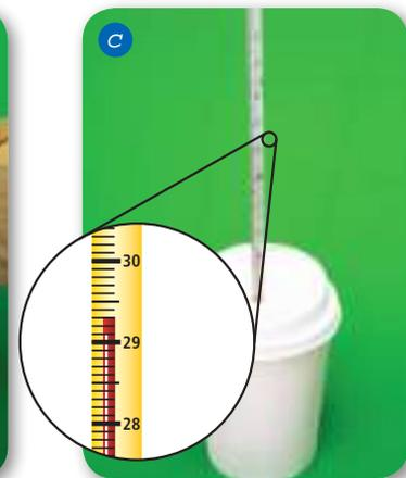
يبين الشكل 5-2 خطوات عمل التجربة. لاحظ أن درجة الحرارة في المسعر تثبت عند  $29.30^{\circ}\text{C}$ ، وهي درجة الحرارة النهائية التي وصل إليها كل من الفلز والماء. فإذا افترضنا أنه لم تُفقد حرارة إلى المحيط، فإن الحرارة التي اكتسبها الماء تكون مساوية للحرارة التي فقدها الفلز. ويمكن حساب كمية الحرارة هذه بالمعادلة:
