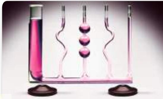
**الشكل 1-12** تنساب السوائل لتأخذ شكل الوعاء الذي توجد فيه، ولكنها لا تتمدد كالغازات لتملأ الوعاء. **استنتج** سبب وجود السائل عند المستوى نفسه في كل من الأنابيب المتصلة معاً.
