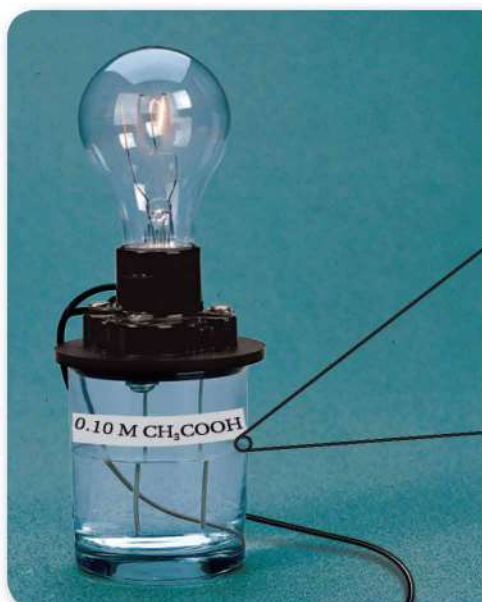
الشكل 3-12 عند وضع الأقطاب في محلول حمض الإيثانويك بتركيز 0.10 M يكون الضوء خافتاً. قارن هذه الصورة بالشكل 5-11. فسر الفرق بين شدتي إضاءة المصباحين بحسب تركيز الأيونات في المحلول.
