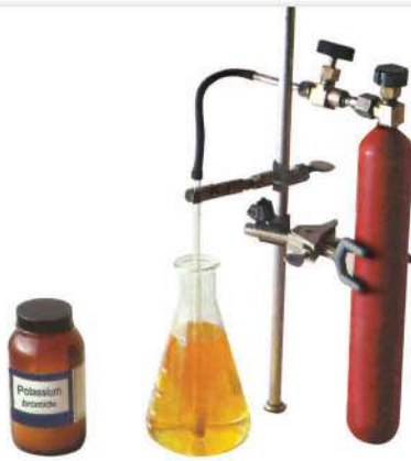
الشكل 4-2 التفاعل بين محلول أيونات البروميد وغاز الكلور هو تفاعل أكسدة، هنا تنتقل الإلكترونات من أيونات البروم إلى الكلور.
