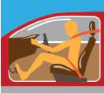
■ الشكل 4-7 يندفع قائد المركبة بشدة نحو الأمام في السيارة التي تسير بسرعة متجهة ثابتة في حالة التوقف المباشر.
