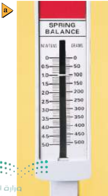
■ الشكل 1-12 عند النظر إلى التدريج بشكل عمودي كما في (a) تكون قراءتك مضبوطة مما لو نظرت بشكل مائل كما في (b).
