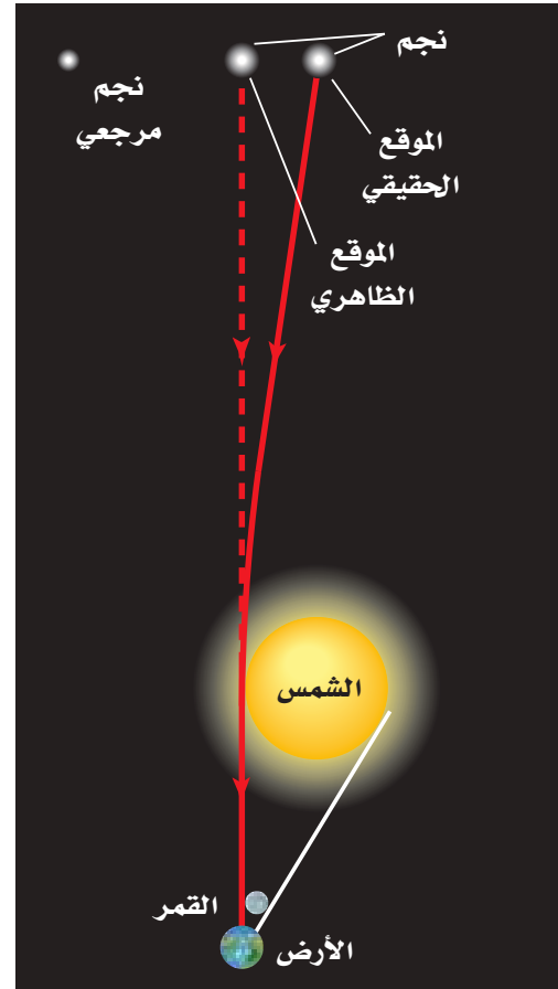
■ الشكل 17-7 الضوء القادم من النجوم البعيدة يتأثر بمجال جاذبية الشمس. الرسم للتوضيح ولا يمثل مقياس رسم حقيقي.
