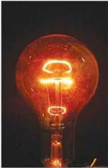
الشكل ١٤ يستخدم العنصر الانتقالي التجميعيون في معايير الإنارة بسبب ارتفاع درجة انصهاره.
