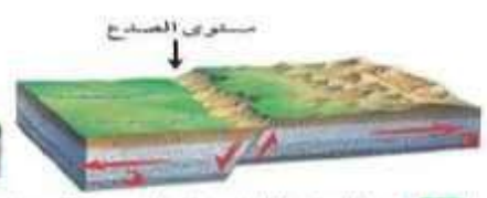
١. ينتج الصدع العادي عندما تسحب الصخور لأجزاء الشد (الشد). ٢. ينتج الصدع العكسي عندما تتعرض الصخور لإجهادات ضغط.
