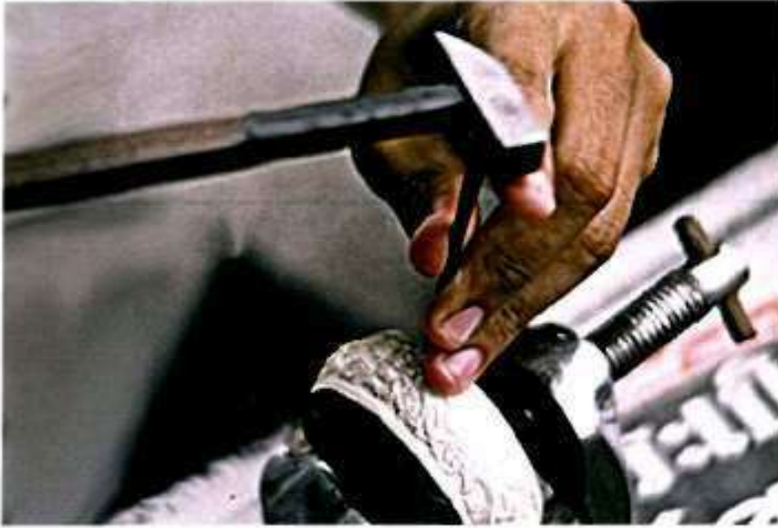
الشكل ١٢ يقوم الحرفي بالنقش على الفلز القابل للطرق للحصول على الشكل المطلوب.
