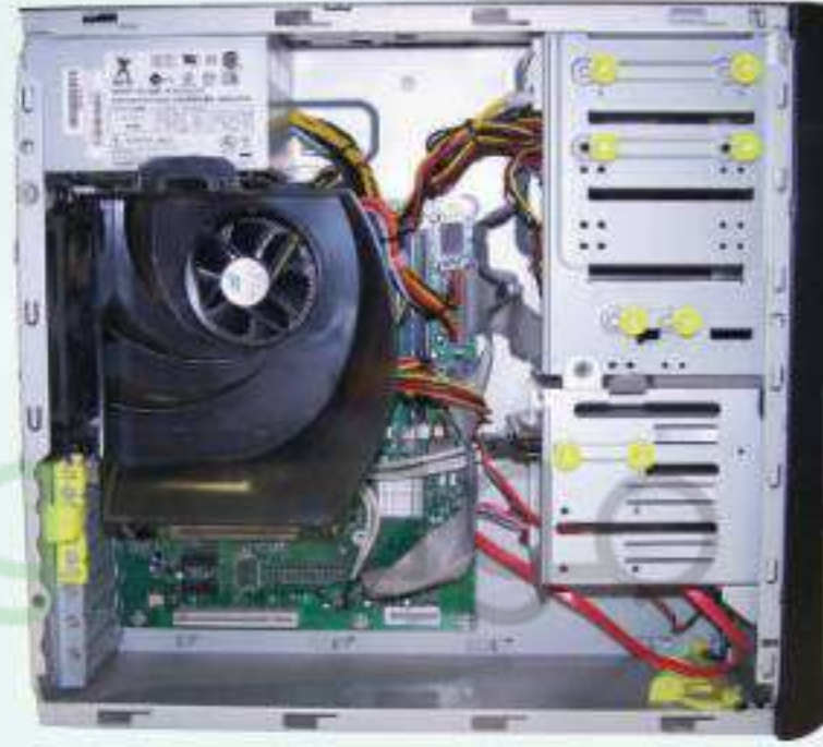
شكل (٢-٤): اللوحة الحاضنة داخل صندوق الحاسب
