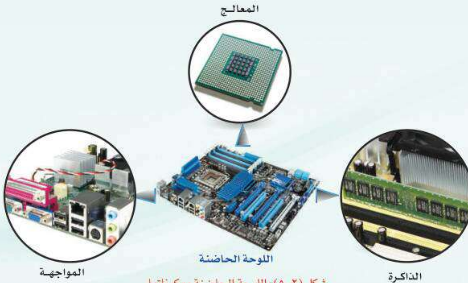
شكل (٢-٥): اللوحة الحاضنة ومكوناتها
