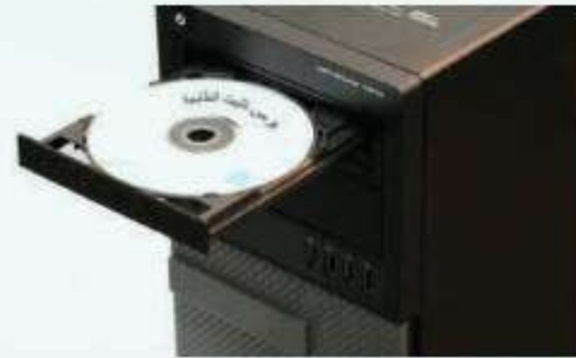
شكل (٢-٢-٥): إدخال القرص الضوئي الخاص بتثبيت الطابعة
