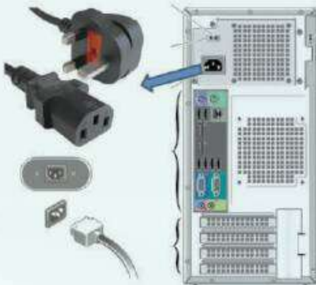
شكل (٢-١-١٠): توصيل سلك الكهرباء الخاص بصندوق الحاسب إلى مصدر التيار الكهربائي
