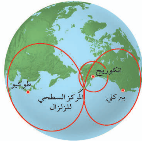
الشكل ٦ بعد حساب المسافة من ثلاث محطات رصد على الأقل يتم رسمها على الخريطة في صورة دوائر ذات أنصاف أقطار تساوي بُعد الزلازل عن المحطة. يكون المركز السطحي للزلازل هو مكان التقاء الدوائر الثلاث.
