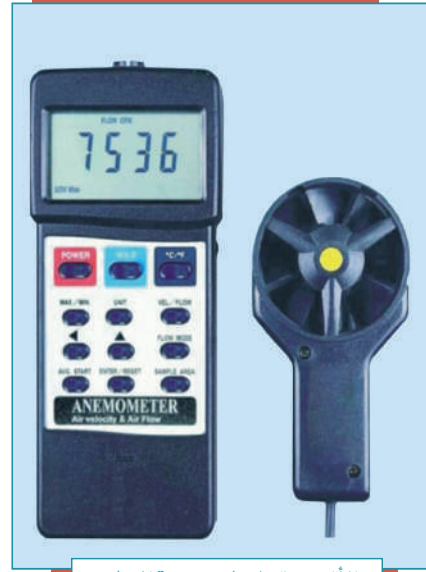
الأنيمومتر لقياس سرعة الرياح
