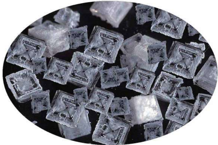
هذا الشكل الكبير يوضح الشكل المكعب لبلورات كلوريد الصوديوم
