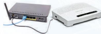
شكل (٨-١): توصيل سلك الهاتف بجهاز المودم
