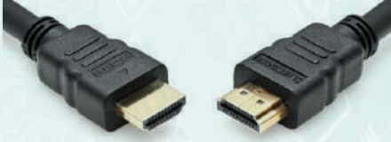
شكل (٨-٢-٢): سلك (HDMI) للتوصيل بين جهاز الحاسب والتلفاز
