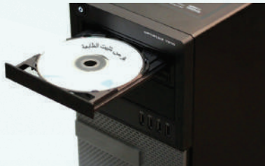
شكل (٥-٢-٢): ادخال القرص الضوئي الخاص بتثبيت الطابعة
