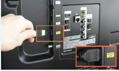
شكل (٩-٢-٢): توصيل أحد طرفي سلك (HDMI) إلى منفذ (HDMI) على التلفاز
